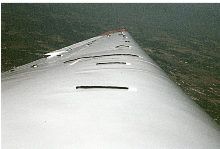
Bild 6. Beginnender Strömungsabriss an der nachgeschobenen Tragflügelhälfte beim Einleiten des Linkstrudeln, Schieben nach rechts (nach außen)
